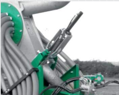
SD nedfælderens stenfælde er som standard forsynet med en manuel åben og luk funktion.
