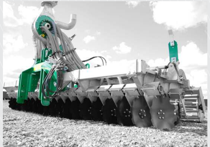
Alle tallerkener er enkeltvis, via elastiske gummi-elementer, ophængt på rammen. Herved opnås maksimal tilpasning til jordoverfladen.
