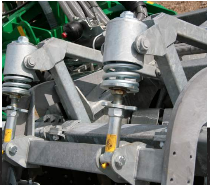
Manuel dybderegulering er standard udstyr.
