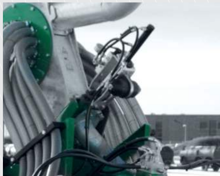
Fordeleren kan forsynes med en hydraulisk spadeventil på stenfælden. Den kan også forsynes med en hydraulisk spadeventil til stenfælden med autoluk. Begge dele er ekstraudstyr.
