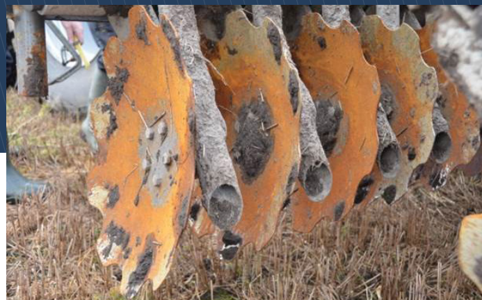
Figur 1: SD gyllenedfælder med beslag monteret, hvor placeringen af gylleudløbet kunne varieres på 3 måder: 1) foran midt i mellem skiverne (foto til venstre), 2) lige foran skiverne og 3) bag skiverne i rillen, som skiverne danner (foto til højre).
