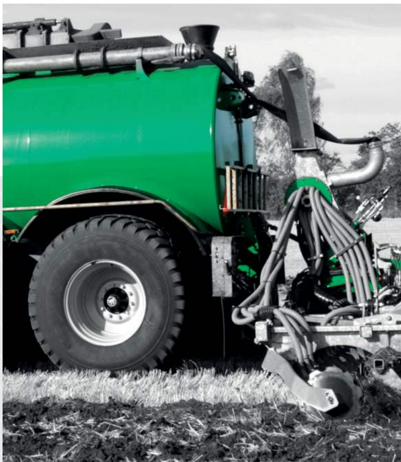
SD nedfælderens kan udstyres med en eller to sidetallerkner, der efterlader en jævn overflade uden render og kanter.
