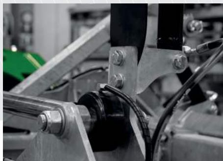
Centralsmøring kan vælges som ekstra udstyr.
