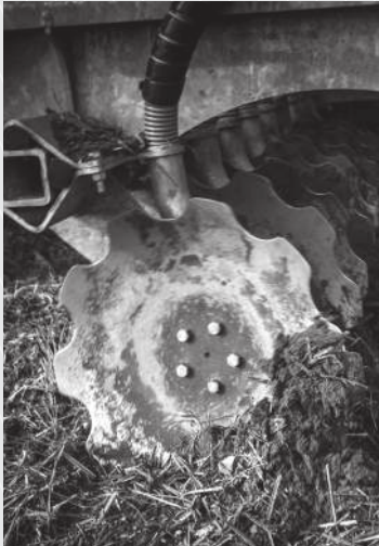
De takkede tallerkener med en diameter på 510 mm arbejder aggressivt og jordsøgende.
