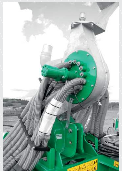
SD tallerkennedfælderens er forsynet med en lodret fordeler med kopskær.
