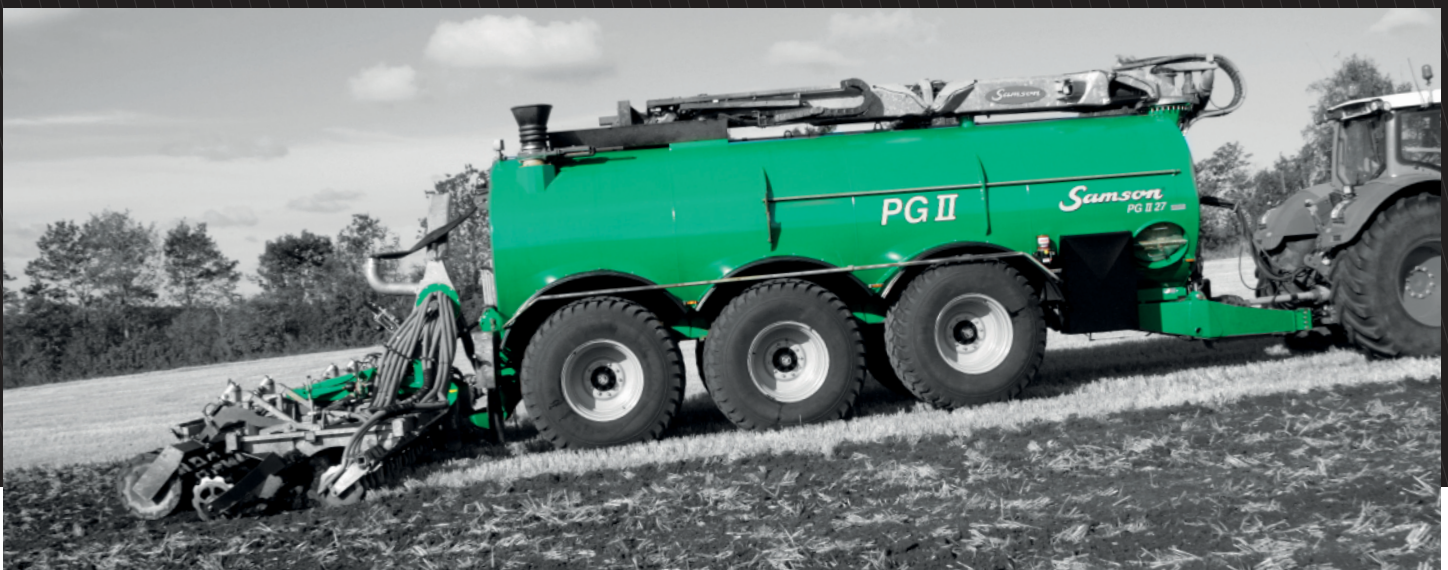
SD nedfælderen bearbejder også jorden perfekt op ad bakke, hvor hastigheden kan være lav.
