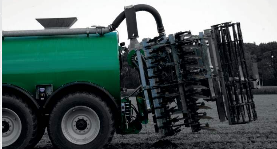
SD tallerkennedfældereren er 2,95 m i transportstilling.
