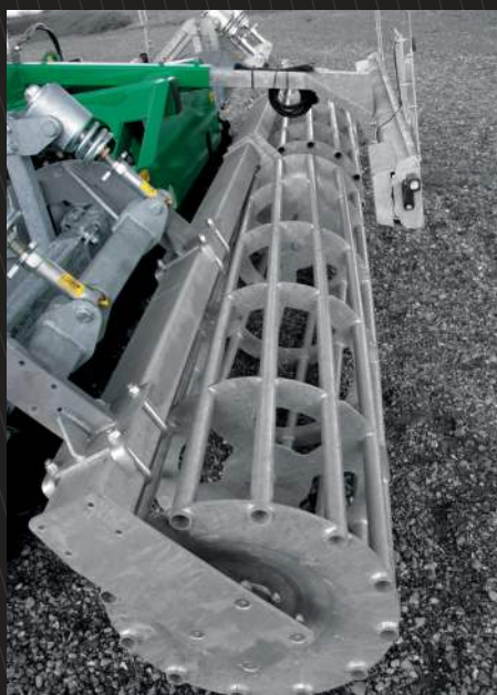
Den store diameter på SD nedfælderens stavpakkervalse sikrer en god bæreevne og en præcis styring af arbejdsdybden.
