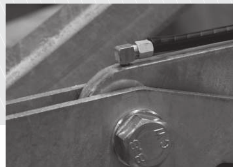
Undgå at få snavs ind i de bevægelige dele med centralsmøring.
