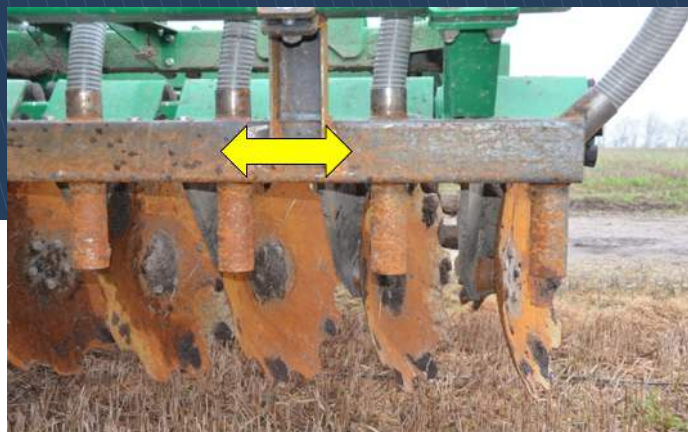
Figur 1: SD gyllenedfælder med beslag monteret, hvor placeringen af gylleudløbet kunne varieres på 3 måder: 1) foran midt i mellem skiverne (foto til venstre), 2) lige foran skiverne og 3) bag skiverne i rillen, som skiverne danner (foto til højre).
