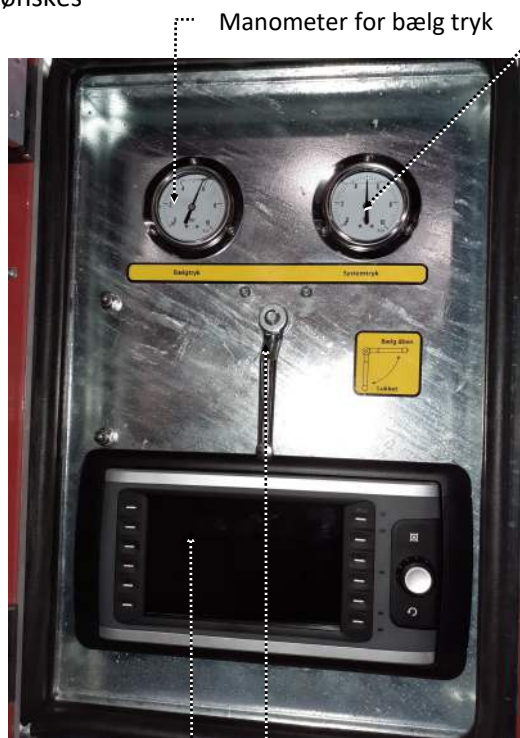
Åben /lukke for luft til bælg
