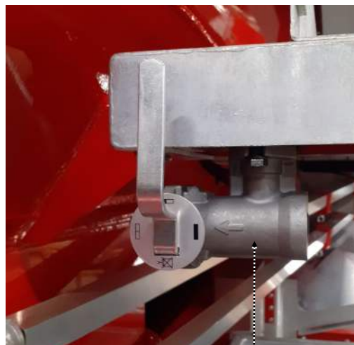
Manuel bremsekraft regulering
