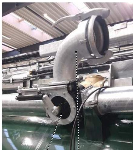
Trevägskranen på baksidan av vagnen för avläsning genom rör
