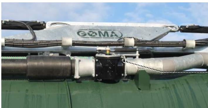
Drift av trevägskranen görs från joystick eller display. Se separat manual.
