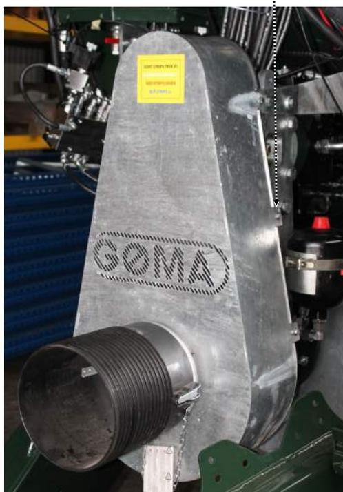
Påfyllning av olja för lagerhus (1,25l max, 1540 motorolja)
