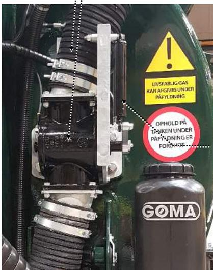
Cylinder til styring af spadeventil
