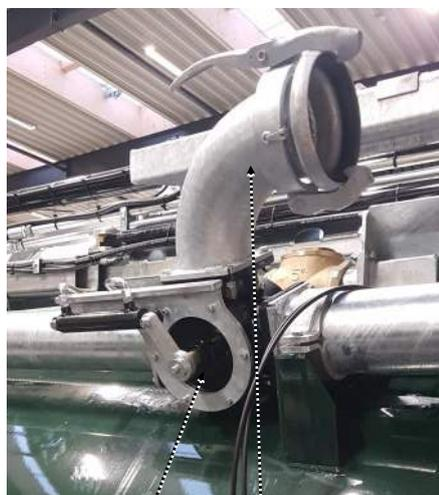
Trevejshane bag på vognen til aflæsning gennem rør
