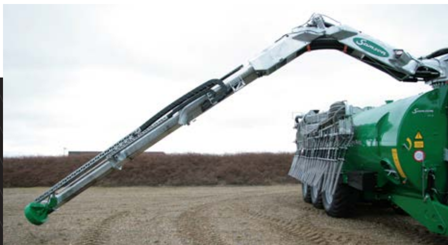
Pumpetårnet er mere kompakt. Det 6" store returrør er integreret i pumpetårnet. De to led køres ud med en teleskoparm.
