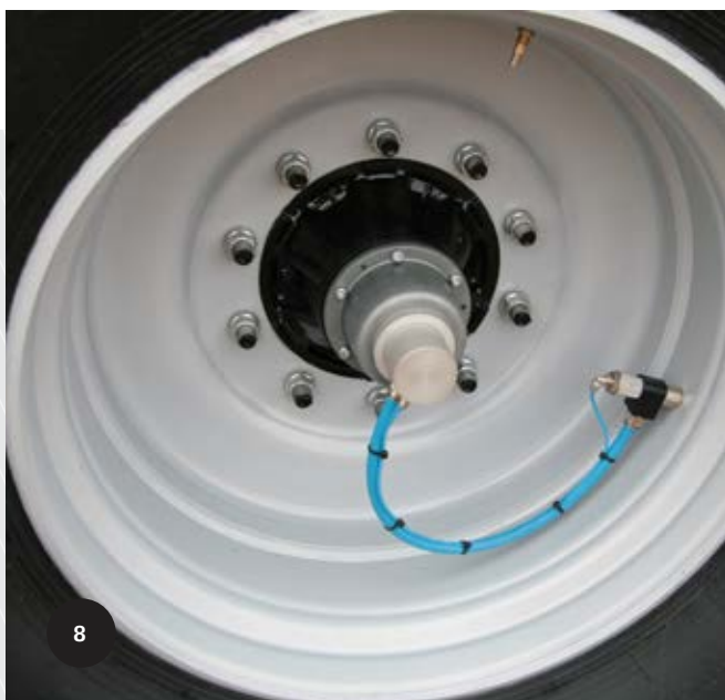
SAMSON AGROs automatiske dæktryksregulering er et 2-kredssystem med lukkeventiler i hvert hjul.
