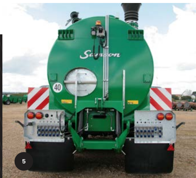
Der er forbedrede tilkoblingsfunktioner mellem vogn og redskab med de nye "push and pull"-lynkoblinger.
