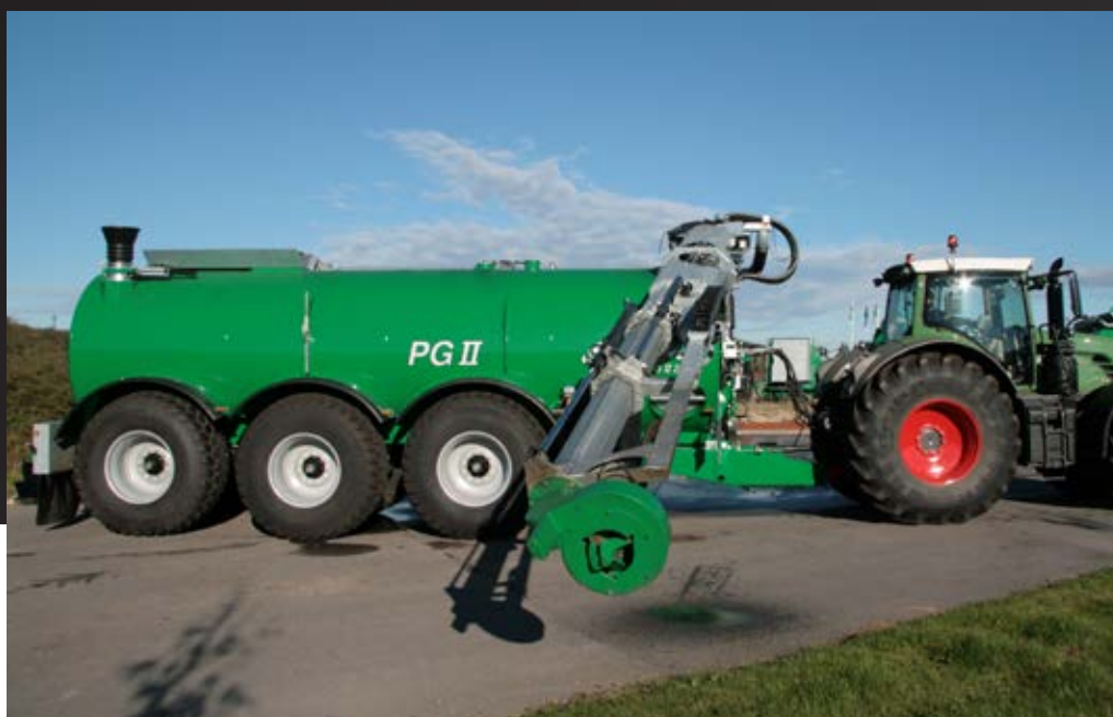
Pumpetårn med teleskoparm.
